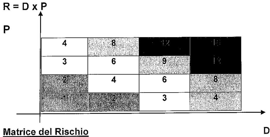
In funzione dell'entità del RISCHIO (Magnitudo), valutata mediante l'utilizzo della matrice già illustrata, e dei singoli valori della Probabilità e del Danno (necessari per la corretta individuazione delle misure di prevenzione e protezione, come indicato nella figura sottostante), si prevedono, in linea generale, le azioni riportate nella successiva **Tabella delle Priorità degli Interventi**.
